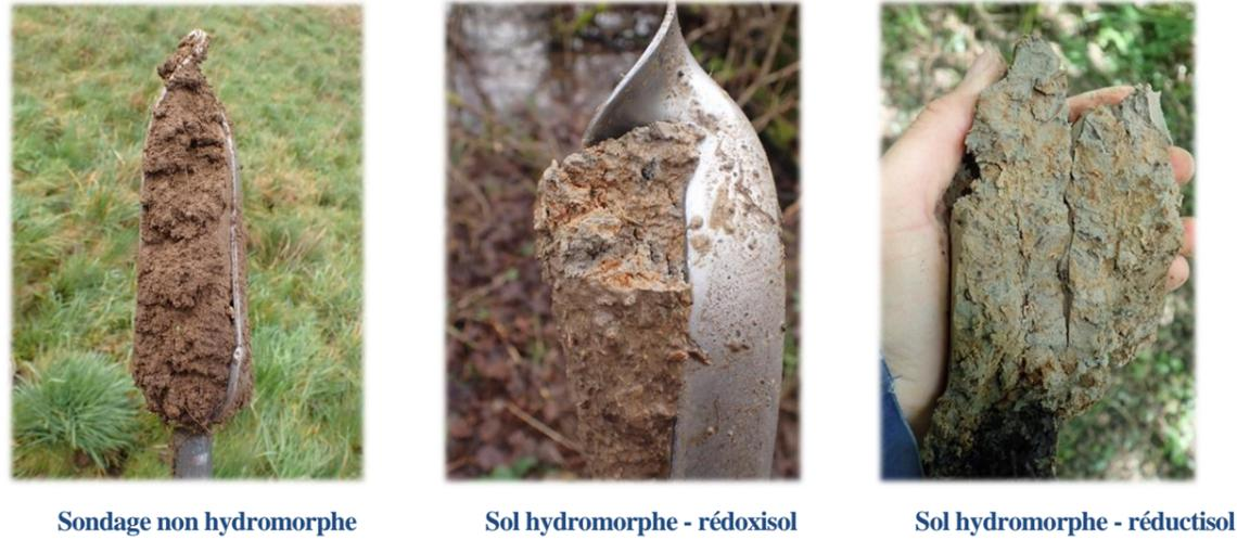
Figure 7 : Exemple de sondages pédologiques
